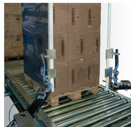
APLICADOR DE CANTONEIRA VERTICAL VCA Dispositivo que aplica cantoneiras de papelão para proteção de palletes APLICADOR DE CANTONERAS VCA Dispositivo para la aplicación de cantoneras para la protección del palé
