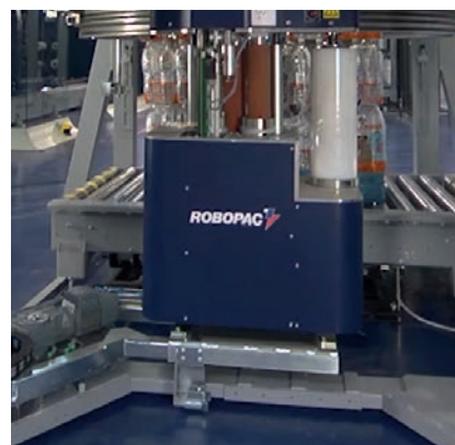
TROCA AUTOMÁTICA DE BOBINA - ARC Dispositivo para trocar bobina ARC - CAMBIO AUTOMÁTICO DE BOBINA Dispositivo de cambio de bobina de film
